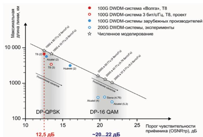
**Рис. 3.** Решения с разной плотностью расположения каналов 100G и 200G. Характеристики DWDM-систем зарубежных производителей оценены примерно на основе доступных данных. В скобках указана спектральная эффективность
