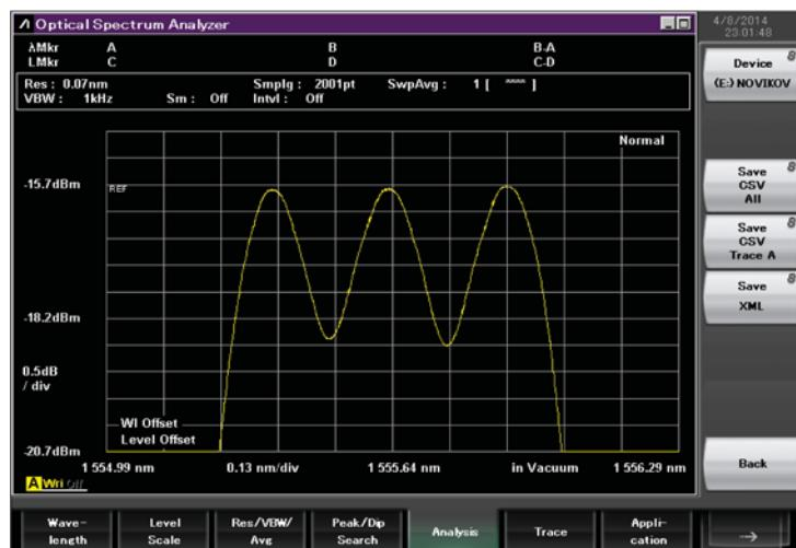
Рис. 2. Спектр суперканала 3x100G в сетке 100 ГГц
