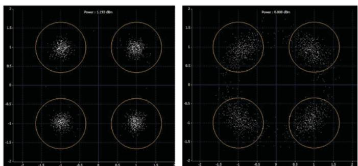
**Рис. 4.** Искажение сигнала DP QPSK 100 Гбит/с при распространении в линии совместно с сигналом OOK 10 Гбит/с (справа). Слева – неискажённый сигнал 100 Гбит/с
