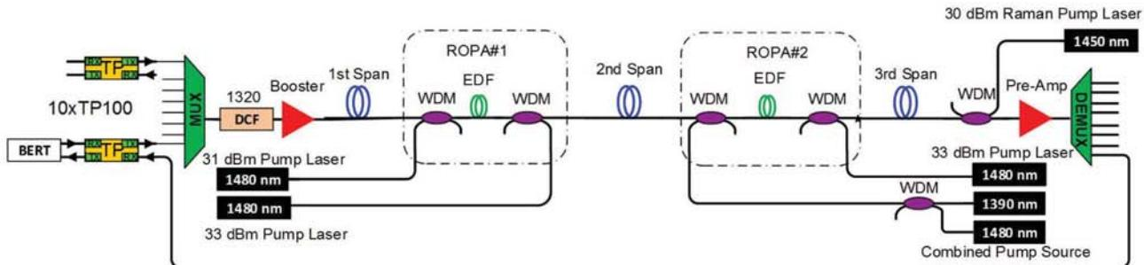
Рис. 8. Схема эксперимента 10 x 100G на 500 км
