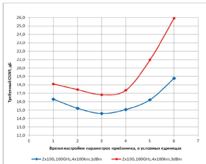
Рис. 5. Зависимость требуемого OSNR от времени настройки параметров приемника, канал 100G в окружении двух каналов 10G с интервалом 100 ГГц, линия 4x100 км с компенсацией дисперсии
