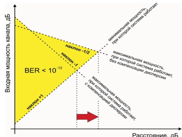
Рис. 7. Допустимая входная мощность канала для многопролётных линий с компенсацией дисперсии и без компенсации дисперсии, в зависимости от протяжённости линии
