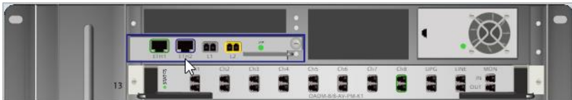
Рисунок 145. Порт ETH2 блока управления на графическом изображении шасси сетевого элемента
