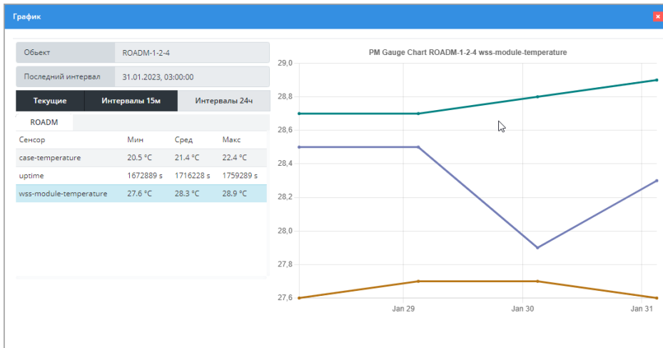
Рисунок 120. Пример измерений с устройства ROADM в режиме 24-часовых интервалов
