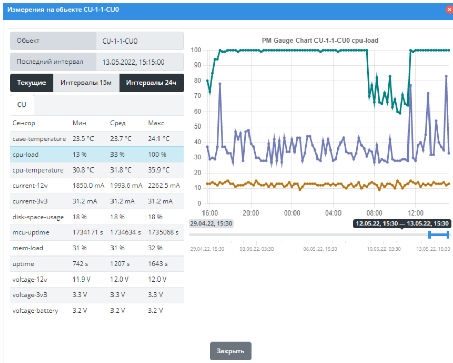
Рисунок 33. Пример измерений нагрузки процессора в режиме 15-минутных интервалов
