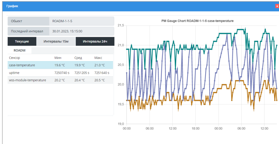
Рисунок 103. Пример измерений с устройства ROADM в режиме 15-минутных интервалов
