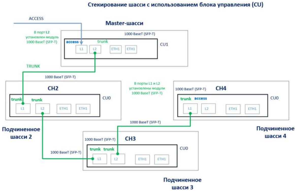
Рисунок 13. Схема соединения шасси в стек при помощи блока управления (CU) без резервирования
