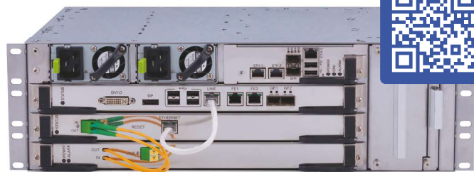
Блок «Дунай» в формате 3U для телекоммуникационной стойки
